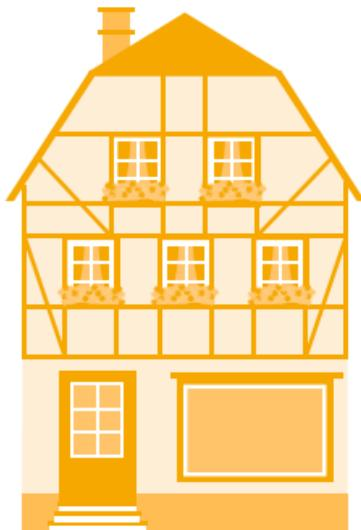
Le colombage est une technique de construction de murs qui remonte à l'époque romaine. Elle met en œuvre deux éléments principaux : une ossature de bois et une maçonnerie (briques, plâtre ou torchis) qui remplissent les interstices.
